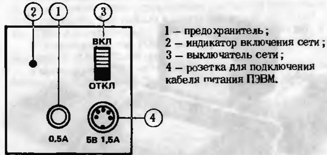
Рис. 4 Блок питания (вид спереди):
